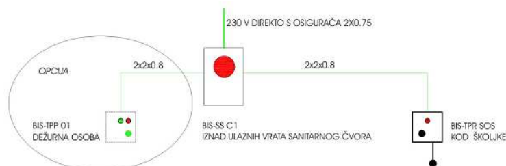
Blok shema spajanja SOS invalid sustava u sanitarnom čvoru za invalide u suterenu.
